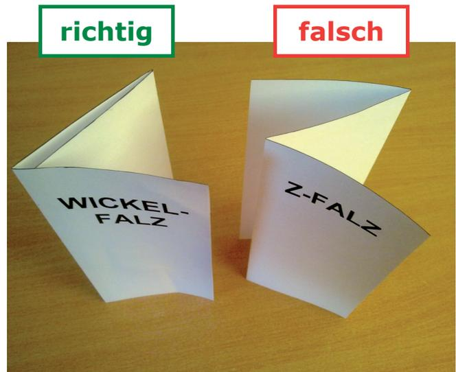
Bei Klappkarten muss sich der Falz an der langen Seite befinden. Sind Klappkarten an der kurzen Seite gefalzt, so verhaken sich die Karten während dem Einzug oder Transport durch Maschine.
