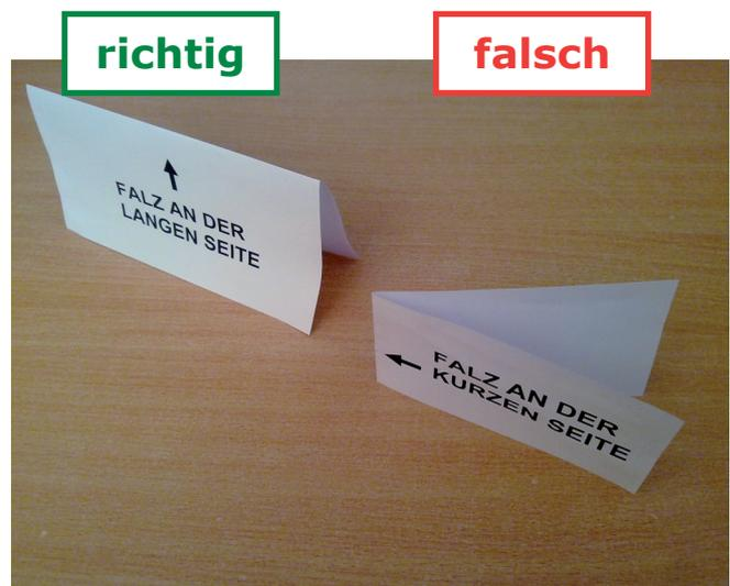
Durch den Transport kann sich eine Hälfte der Karte verhaken. Durch das Verhaken wird eine Hälfte der Karte beim Transport gebremst, währenddessen die andere Hälfte weiterläuft. Dadurch dreht sich die eine Hälfte der Karte (2) und erzeugt Maschinenstopps.
